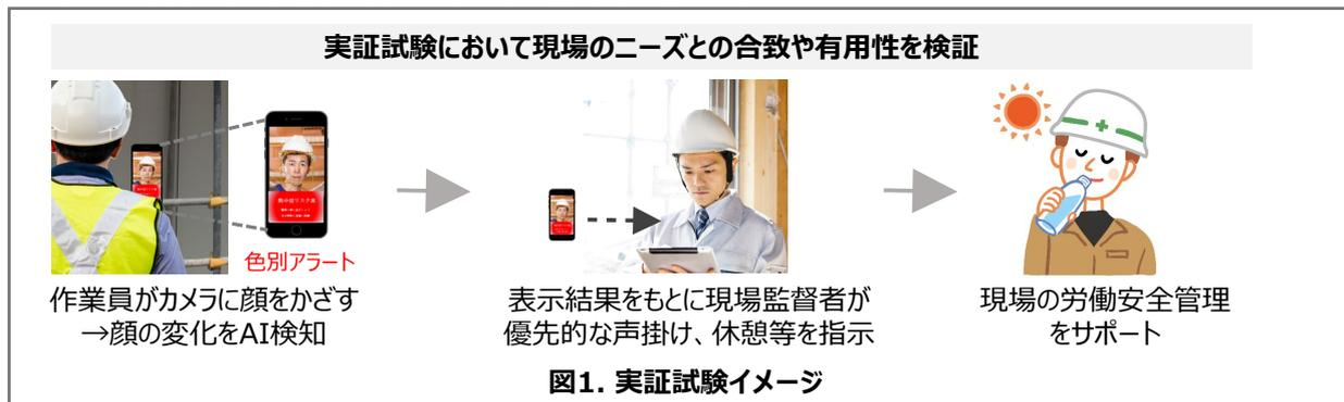
実証試験では、建設現場の休憩所入り口など作業員の導線上に専用のカメラ型デバイスを設置し、朝礼前や昼休憩前に使用いただき、現場のニーズとの合致や有用性を検証したい考えです(図 1)。
